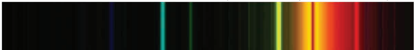
Espectro de un LED de 4100k
