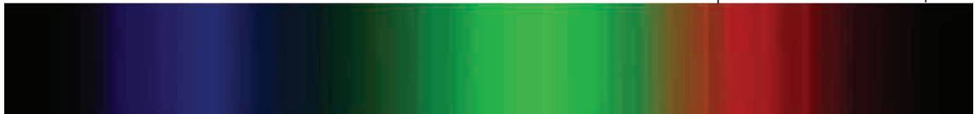
Espectro de un LED de 4100k
